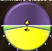
Éclairage direct extensif
