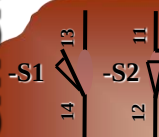
détecteurs fin de course à action mécanique
